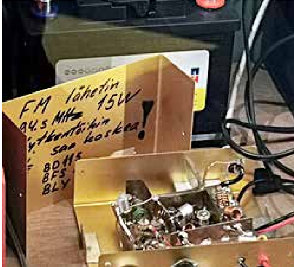
Bilden visar en 15-watts FM-sändare som användes för att sända piratkopierade sändningar i Tammerfors på 89-talet
