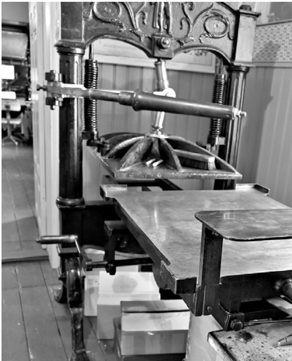
Tämä 1800-luvun alun käsipainokone on ollut kirjapainossa Vanhassa Vaasassa. On todennäköistä, että Vasabladetin edeltäjä, sanomalehti Ilmarinen, painettiin tällä painokoneella. Kun Vaasa paloi vuonna 1852, painokone putosi lattian läpi kellariin ja kaikki 4 jalkaa murtui, mutta painokone voitiin korjata ja käyttää tämänkin jälkeen. Kirjapainokone on nyt Stundarsin Kirjapainomuseossa, lähellä Vaasaa.
