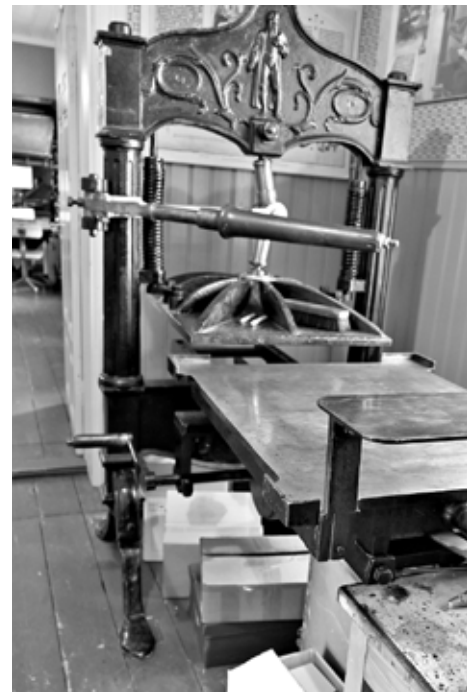
Denna handtryckspress från början av 1800-talet har funnits i ett tryckeri i Gamla Vasa. Sannolikt har Vasabladets föregångare tidningen Ilmarinen tryckts med denna press. Då Vasa liksom tryckeriet brann år 1852 föll pressen genom golvet till källaren och bröt alla 4 benen, men tryckpressen kunde repareras och användes också efter detta. Tryckpressen finns nu på Tryckerimuseet i Stundars, nära Vasa.
