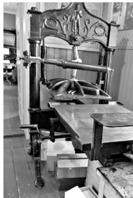
Tämä 1800-luvun alun käsipainokone on ollut kirjapainossa Vanhassa Vaasassa. On todennäköistä, että Vasabladetin edeltäjä, sanomalehti Ilmarinen, painettiin tällä painokoneella. Kun Vaasa paloi vuonna 1852, painokone putosi lattian läpi kellariin ja mursi kaikki 4 jalkaa, mutta painokone voitiin korjata ja käyttää tämänkin jälkeen. Kirjapaino on nyt Kirjapainomuseossa Stundarsissa, lähellä Vaasa.
